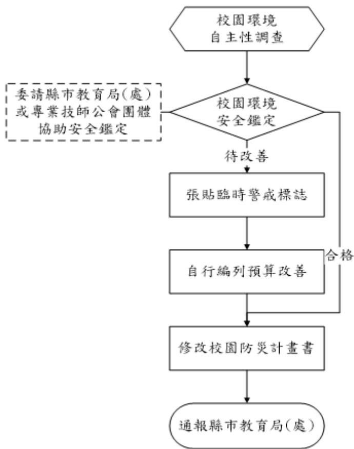
圖 5-1 坡地災害平時預防工作事項流程圖
